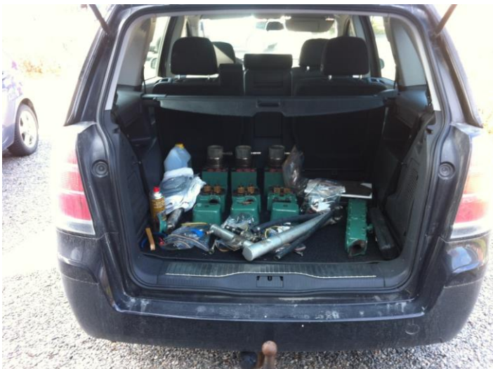
Komplett overdel, nymalt med 3 stempel montert inn i sylindrene.
