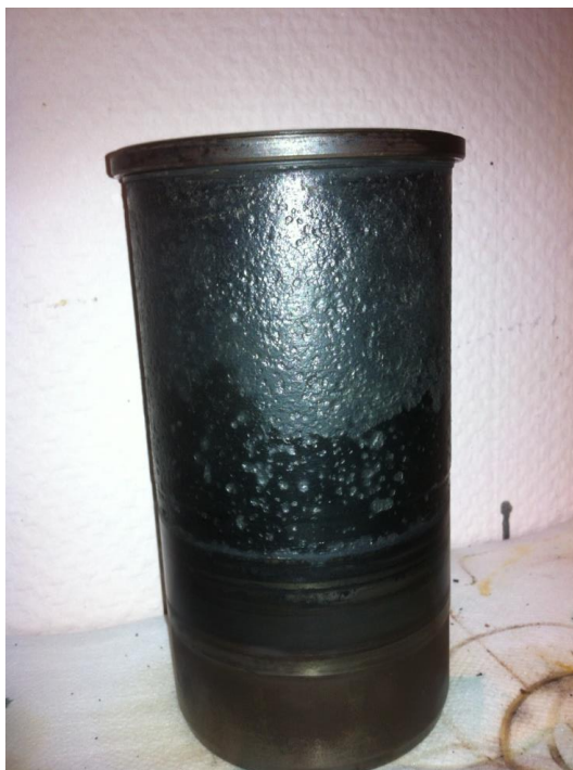
Tilstanden til sylindrene. Sort belegg = grafitrikt belegg(karbon), blank overflate = stål.
