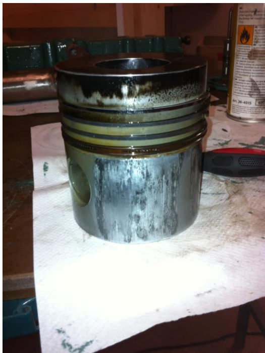
Dette er representativt for sylindere 2 og 3. I rødt merke over er det etter mitt skjønne "kaldsveiset" en stålbit inn i aluminiumsstempelet.
