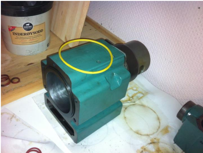
Nymalt med honet sylinter installert og motor o-ring for tetting mot motorblokka klar til bruk.
